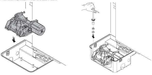
Lubrificare la leva di trasmissione.
