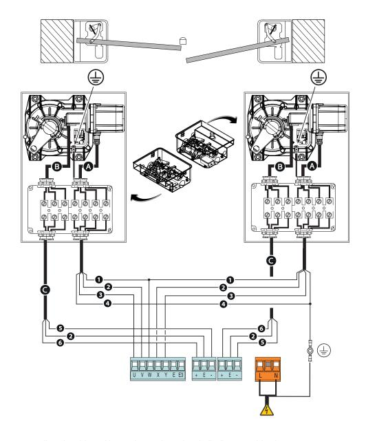
Verificare il corretto senso di rotazione del motoriduttore ed eventualmente invertire il collegamento dei cavi marrone e nero.
