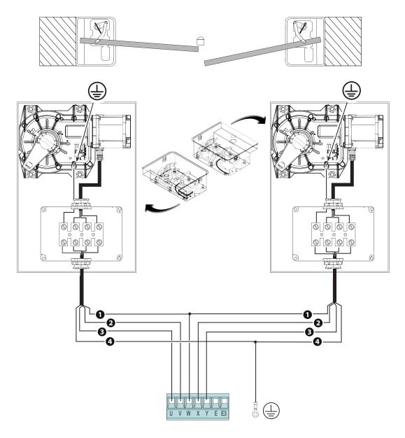
Werificare il corretto senso di rotazione del motoriduttore ed eventualmente invertire il collegamento dei cavi marrone e nero.
