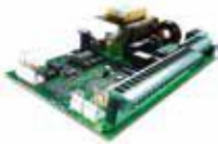
Scheda elettronica 624BLD (incorporata nell'automatismo)
