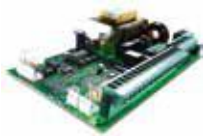
Scheda elettronica 624BLD (incorporata nell'automatismo)
