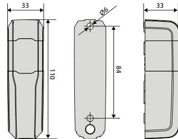
Coppia di fotocellule orientabili, progettate per offrire un elevato grado di flessibilità installativa grazie alle dimensioni compatte, alla possibilità di orientare il fascio di 90° in orizzontale sia verso destra sia verso sinistra (180° totali), e ad un range di alimentazione esteso 12 - 33Vac e 15 - 35Vdc. Portata nominale 20 metri.
