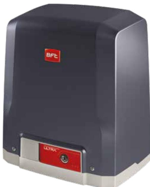
Operatori 24V per cancelli scorrevoli fino a 600kg, ad uso intensivo. Velocità massima dell'anta fino a 16m/min. Controllo della coppia tramite tecnologia D-track. Finecorsa magnetici per installazioni più rapide, precise e perfettamente integrate con l'architettura del sito. Centrale di comando a display, predisposta per comunicazione con protocollo U-link. Uso residenziale.
