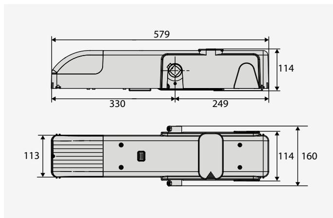
Operatore elettromeccanico ad uso residenziale per l'automazione di porte da garage basculanti. La centrale di comando incorporata permette la gestione del secondo operatore per installazioni su porte di grandi dimensioni o con porta pedonale integrata. La tecnologia a microprocessore consente inoltre di gestire la coppia dei motori con la massima precisione e in tutta sicurezza.
