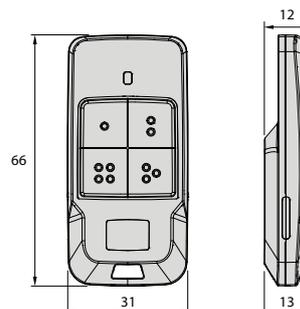
Gamma di radiocomandi composta da modelli a due e quattro canali, tutti con led puntiformi di colore rosso, disponibili in quattro colori e con possibilità di una personalizzazione nella parte frontale. Supportano la nuova tecnologia U-Security e sono alimentati da una batteria a bottone da 3V di facile reperibilità.
