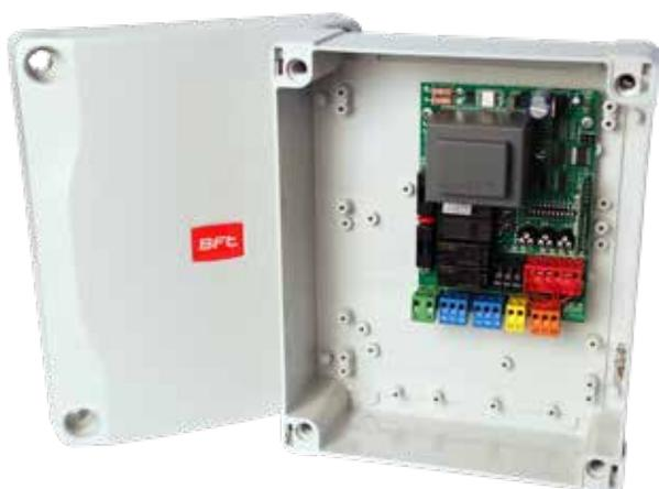
Quadro di comando a dip switch e potenziometri per uno o due operatori da 230V/300W utilizzato nei cancelli battente, con gestione di una costa sensibile e possibilità di verifica degli ingressi sicurezza. Può gestire anche il collegamento con una elettroserratura EBP oppure con una ECB (con scheda aggiuntiva ME). Il ricevitore radio è incorporato con tecnologia rolling code. Le morsettiere sono colorate ed estraibili per rendere più agevoli le operazioni di cablaggio.
