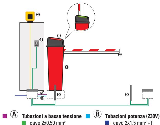
ATTENZIONE: La configurazione può essere modificata in funzione della "analisi dei rischi" specifica di ogni installazione (Rif. Norme Europee UNI-EN 12445 e 12453). Dal costo indicato sono escluse le spese per l'installazione e per la predisposizione di opere murarie, elettriche e fabbrili.
