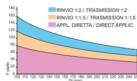
Per valutare la corretta applicazione dell'automazione rilevare la forza necessaria per sollevare la porta (valore rilevabile anche sulla documentazione della porta stessa) e il diametro del tamburo avvolgifiuni. Il grafico consentirà di determinare la possibile applicazione del motoriduttore e la necessità di utilizzo di un kit rinvio applicazione fuori asse (vedere accessori).
