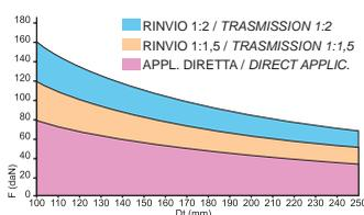
Per valutare la corretta applicazione dell'automazione rilevare la forza necessaria per sollevare la porta (valore rilevabile anche sulla documentazione della porta stessa) e il diametro del tamburo avvolgifiuni. Il grafico consentirà di determinare la possibile applicazione del motoriduttore e la necessità di utilizzo di un kit rinvio applicazione fuori asse (vedere accessori).
